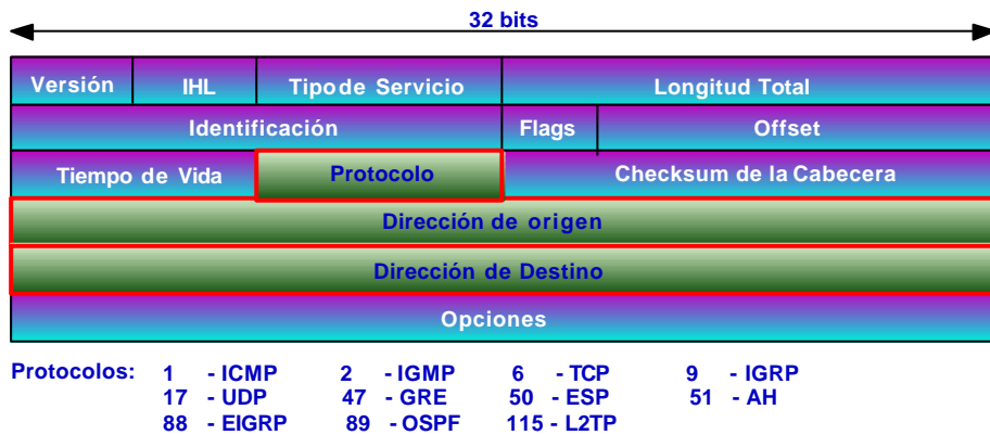
Fig. 4. Cabecera de un paquete en IPv4. En destacado los campos que habitualmente inspeccionan los Cortafuegos.
